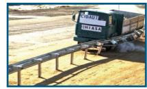
**Ensayo TB 42**Camión de 10.000 kg., a 70 km/h y 15°
